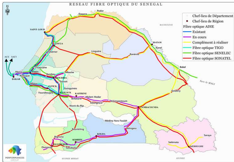
Figure 2 : Etat du backbone fibre optique au Sénégal en 2016
